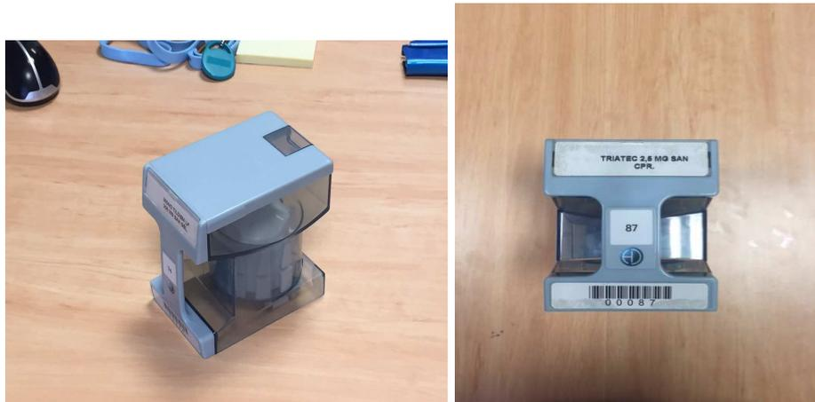
Photo 15 : Cassette calibrée pour les médicaments gérés par l'automate
