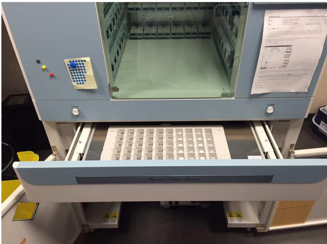
Photo 14 : Mise en place dans l'automate d'un plateau pour les médicaments hors cassette calibrée
