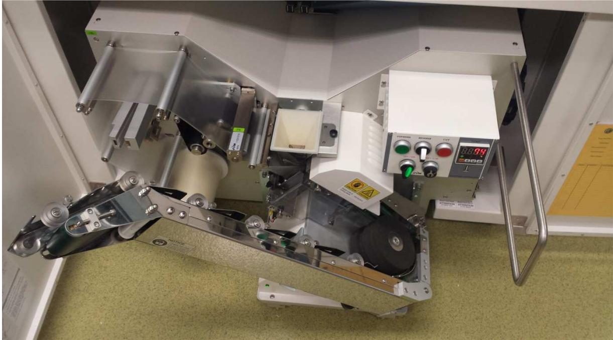
Photo 13 : ensacheuse permettant le conditionnement par gravité en sachet monodose nominatif.
